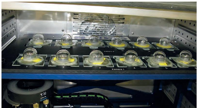
**Bild 2: Kontaminierte Proben auf dem Kamerasystem**
