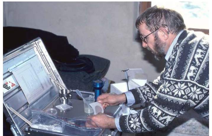
Wasseranalyse mit mobilem SKH-Labor.
